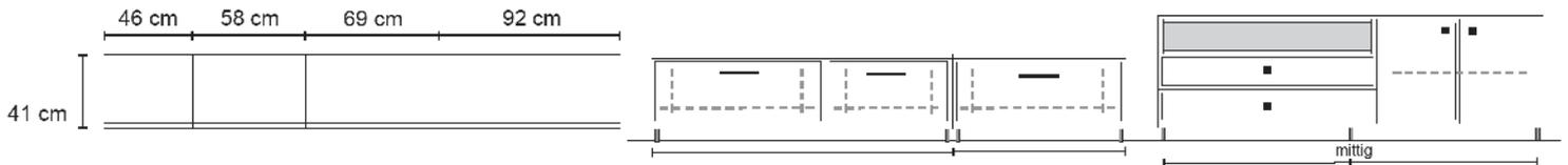
ab 250 cm wird die durchgehende Sockelplatte zwischen zwei Korpusen geteilt. Entsprechend werden die Füße am Anfang und am Ende der beiden Platten platziert. Hintere Stützfüße werden konstruktionsabhängig ab 2 Korpusen von uns mitgeliefert werden.
