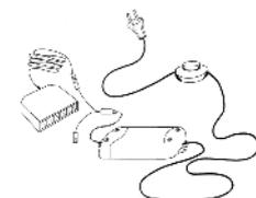
Elektronisches Vorschaltgerät (EVG) mit Fußschalter und mit Fußschalter und Verteiler für maximal 7 Beleuchtungselemente
